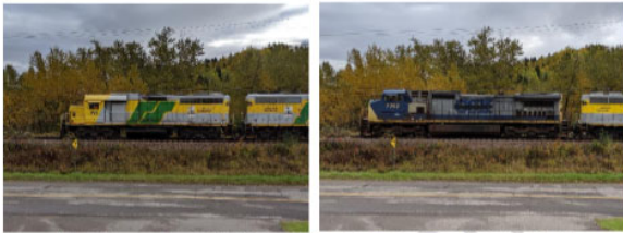
Figure 2: Locomotive à 4 essieux (Gauche) et locomotive à 6 essieux (Droit)
