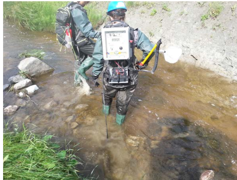
Fig. 40. Photographie de la pêche électrique effectuée dans le seuil observé à la station. Le substrat du lit est composé de blocs, de sable et d'argile.
